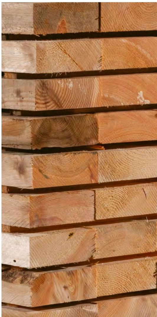
Le bois de coffrage, comme son nom l'indique, est un bois utilisé pour la réalisation d'ouvrage en béton afin d'y maintenir le béton jusqu'à son séchage. Cela inclut les planches, les chevrons, les madriers et les bastaings de coffrage.
